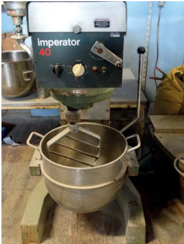
Met de deegmenger worden vloeistoffen op vaste stoffen gebracht.
