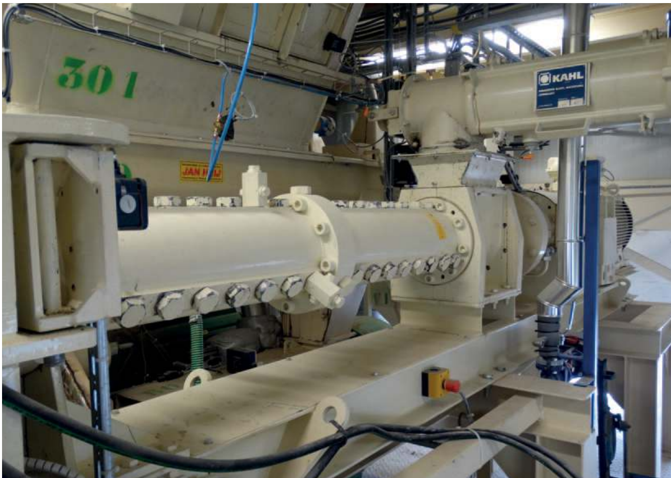
De expander is van Kahl. Omwille van de beschikbare ruimte wordt deze rechtstreeks aangedreven.
