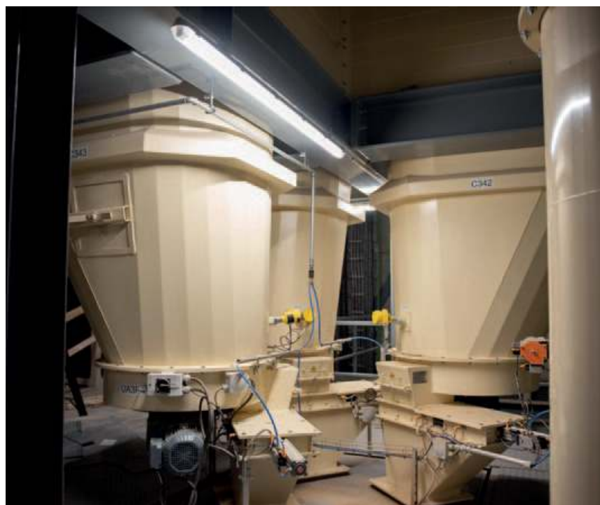
De drie persmeelcellen zijn altijd gevuld, klaar voor de volgende productiecharge.
