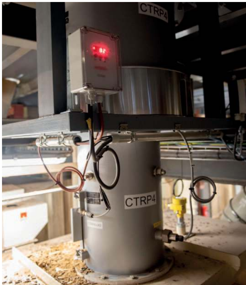
De Kahl Rotospray wordt gebruikt voor het coaten van de pellets en kan ook worden gebruikt voor het toevoegen van enzymen, vitaminen en geur- en kleurstoffen.
